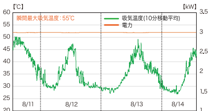
吸気温度およそ27°C~50°Cの過酷条件の中、72時間連続で安定した定格電力(3kW)を供給。(試験期間: 2020.8.11 12:30 ~ 2020.8.14 12:30)
