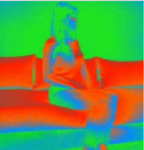
一般的なヒーター(1600W) 拡散し、熱が十分に届かない状態
